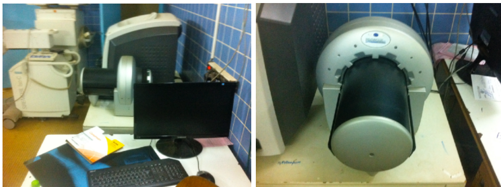
Image 32 : L'ordinateur équipé du logiciel de traitement d'images, le scanner pour films analogiques et l'imprimante numérique du service de radiologie. Crédits Image : Nicolas Mabillard
