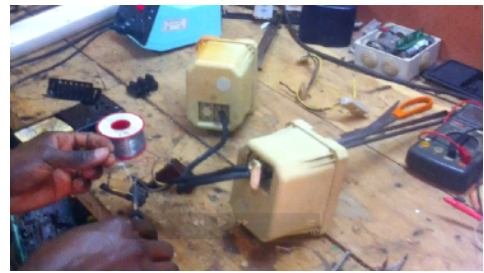
Image 25 : Rétablissement du courant électrique entre deux rouleaux de la développeuse Crédits Image : Nicolas Mabillard
