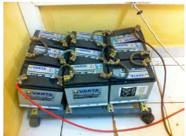
Image 15 : Neuf batteries couplées pour détourner l'AMX™-4 Crédits image : Nicolas Mabillard
