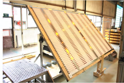
(d) Attachment of the reinforcing aluminum bars.
