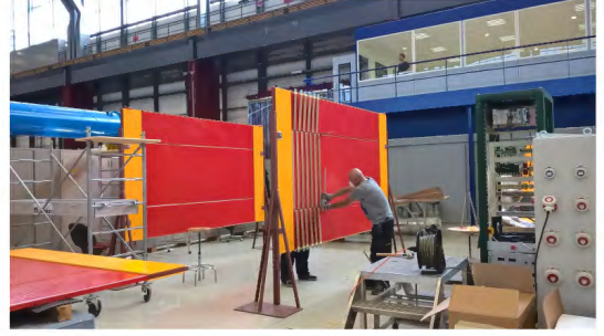
(d) Folding Aluminum coil in a swing pattern
