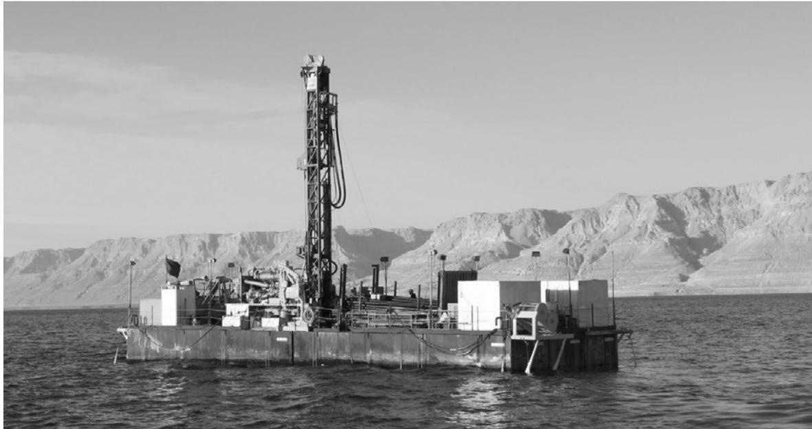
Le prélèvement des carottes sédimentaires se fait à partir d'une plateforme pour des longues carottes (ci-dessus, Mer Morte) ou d'un petit bateau bateau pour des carottes courtes (ci-dessous, lac de Zürich). Des tubes sont descendus grâce à un carottier. Il s'enfoncent dans le sédiment qui est « mou » et permettent de remonter une carotte.
