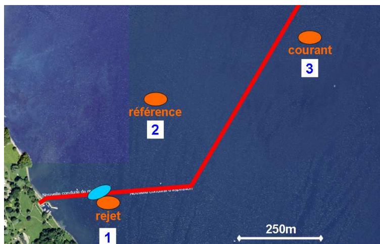
fig. 7-2 Emplacements des bouées de mesures numérotation des principaux emplacements de mesure (en bleu); conduites du réseau GLN (en rouge) et emplacement de son rejet (en bleu clair)
