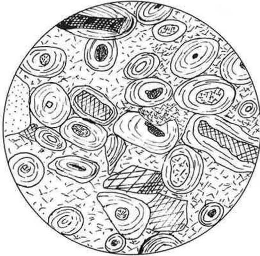
Fig. 10. Coupe N° 50. L.N. Grossissement  $30 \times$ . Minerai non métamorphisé. Oolithes de teinte claire et de section circulaire. Noter l'absence de pigmentation limonitique.
