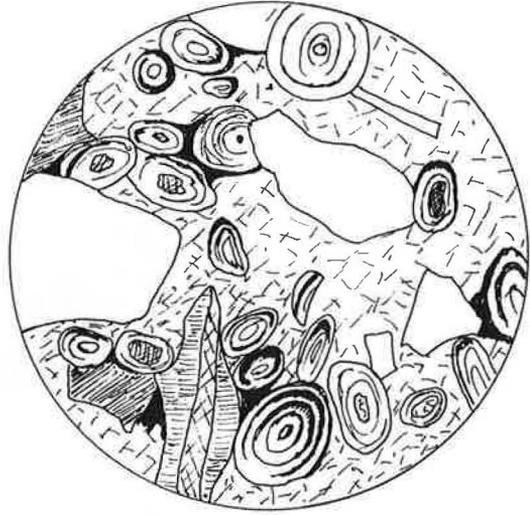
Fig. 11. Coupe N° 4. L.N. Grossissement  $30 \times$ . Minerai en voie de transformation. Noter l'apparition du pigment noir à l'intérieur des oolithes et entre ces dernières.
