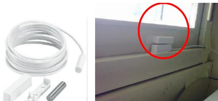
Figure 1-14 : Photo du capteur FU7350W (gauche) et photo du capteur mis en place sur la fenêtre (droite)
