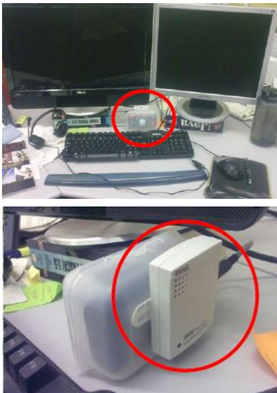
Figure 1-11 : Photo du HOBO U12 installé pour mesuré la température de l'air de la pièce
