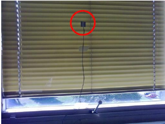
Figure 1-9 : Photo de la sonde TMC20-HD installée pour mesurer la température du vitrage
