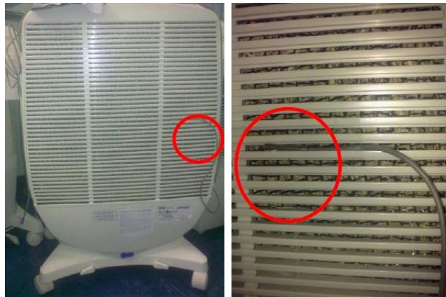
Figure 1-10 : Photo de la sonde TMC20-HD installée pour mesurer la température à l'entrée du rafraîchisseur adiabatique
