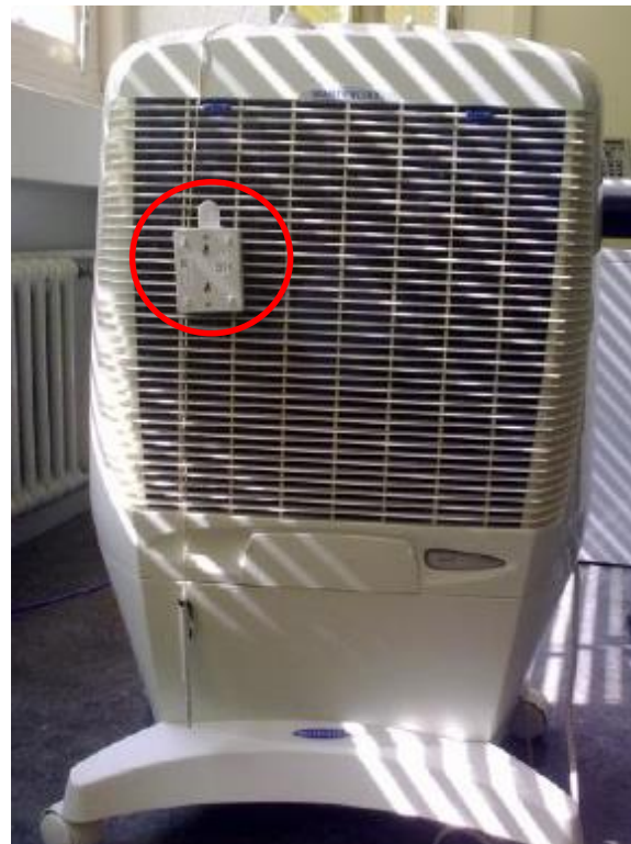
Figure 1-12 : Photo du HOBO U12 installé pour mesuré la température de l'air à la sortie des appareils
