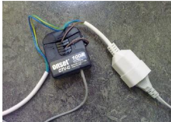
Figure 1-15 : Photo du capteur de courant CTV-C mesurant un courant double
