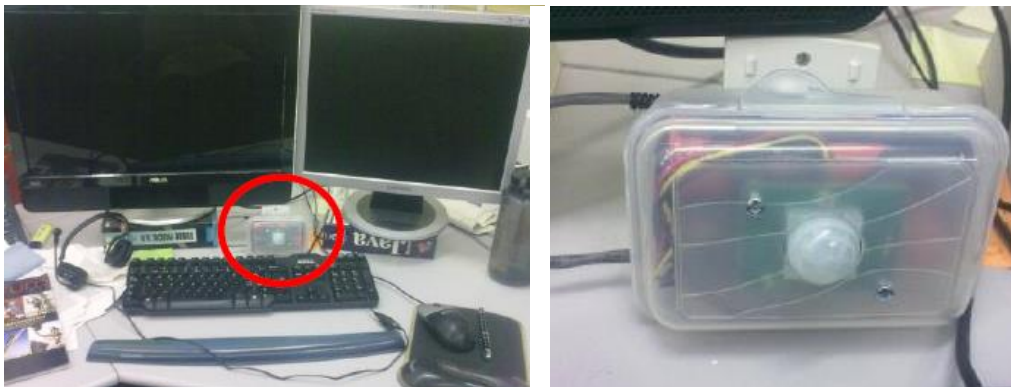
Figure 1-13 : Photos du capteur pyroélectrique à infrarouges placé sur un bureau
