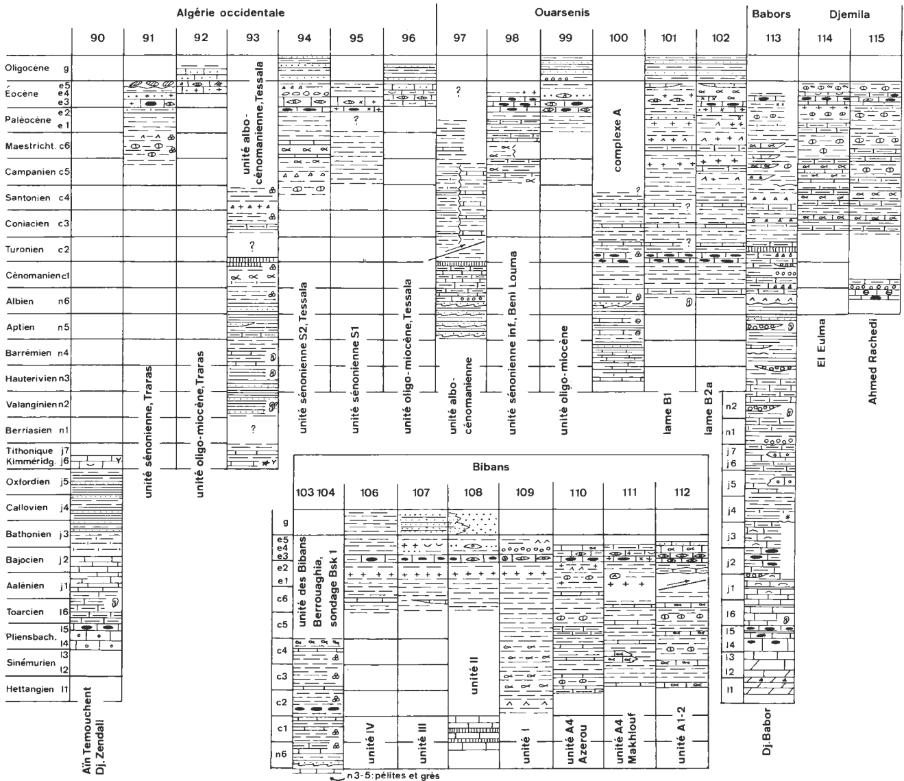
Fig. 12. - Schéma faciès/étage pour les séries des unités bas-telliennes (Lias-Oligocène, domaine externe); localisation Pl. h.t. I; légende lithologique fig. 10.
