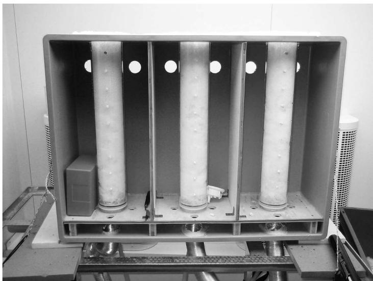
FIG. 2.10 – Dispositif expérimental pour l'observation de la mobilité des algues de neige dans des colonnes de neige sous conditions contrôlées. Pendant l'expérience, le dispositif expérimental est fermé sur le côté à l'aide d'un couvercle de sorte que la lumière ne pénètre que par le haut des colonnes.
