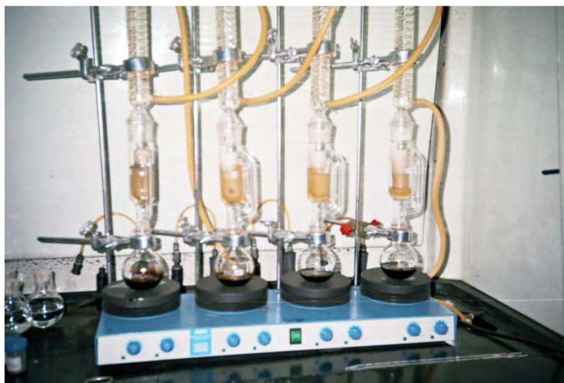
Fig. 3.10. Extracción de bitumen de muestras de carbón y lutita carbonosa de la Formación Amagá. Bitumen extraction from coal and coaly shale samples of Amagá Formation.
