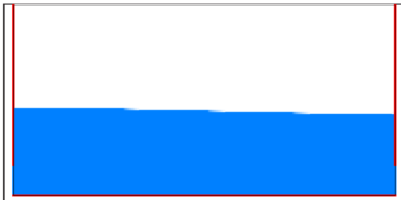
FIG. 5.24 – Simulation de sédimentation mono-bief en régime stationnaire, avec ouverture des vannes à 15. Dans ce cas, il n'y a plus de dépôt : la vitesse de l'écoulement est suffisamment importante pour que l'érosion emporte rapidement toute particule qui sédimenterait.
