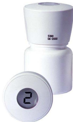
Figure 4.4 : Pilulier électronique MEMS avec écran LCD
