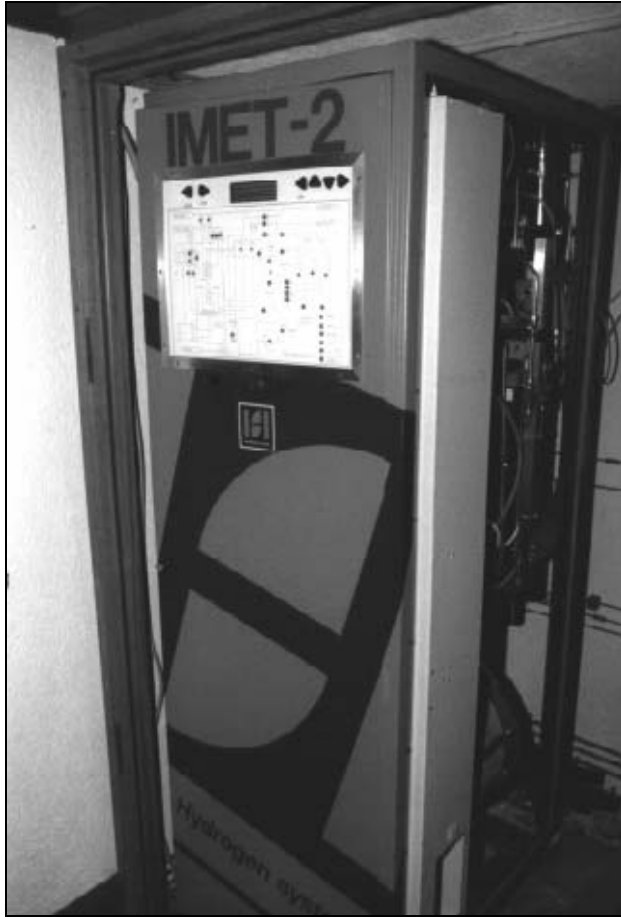
Figure 4: L'électrolyseur vu de face, avec un tableau de bord permettant de suivre l'état de l'électrolyseur et des différents sous-systèmes avals.
